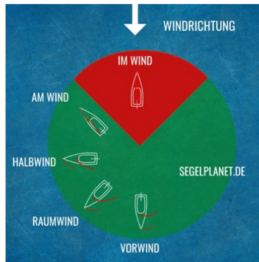
Abb. 2: Richtungen gegen den Wind, in die ein Segelschiff fahren kann
