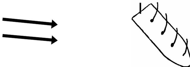
Das Schiff fällt ab (= Drehbewegung, vom Wind weg), bis der Wind genau von achtern kommt.
